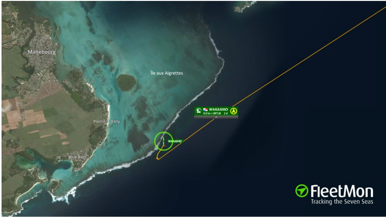
Abbildung 3: Darstellung der Route über das AIS-Signal der Wakashio und des Riffes, auf dem das Schiff aufgelaufen ist. Deutlich zu sehen ist auch die Verdriftung des Schiffes nach dem Aufliegen in nordöstliche Richtung. Bildquelle: FleetMon 3
