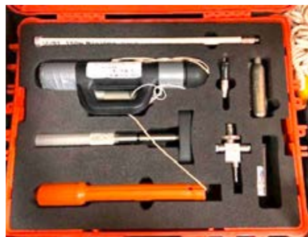
Leinenschussgerät zum Herstellen einer Schleppverbindung von Schiff zu Schiff
