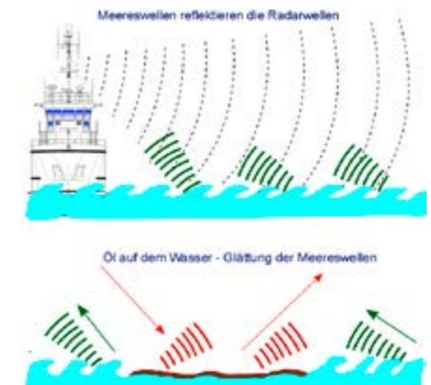
Prinzip der Ölerkennung auf der Wasseroberfläche
